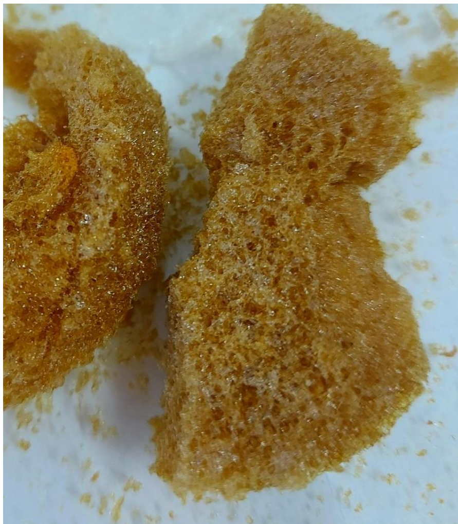
Figura 3 – Nanotubos de carbono estabilizados em esponja de quitosana - CNT-CS.
