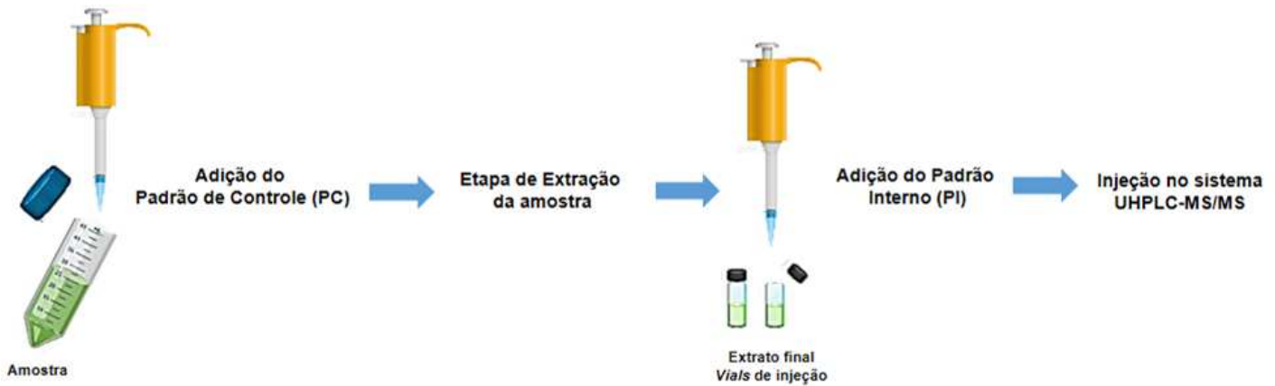
Figura 5 – Etapa da adição do Padrão Interno (PI) e do Padrão de Controle (PC).
