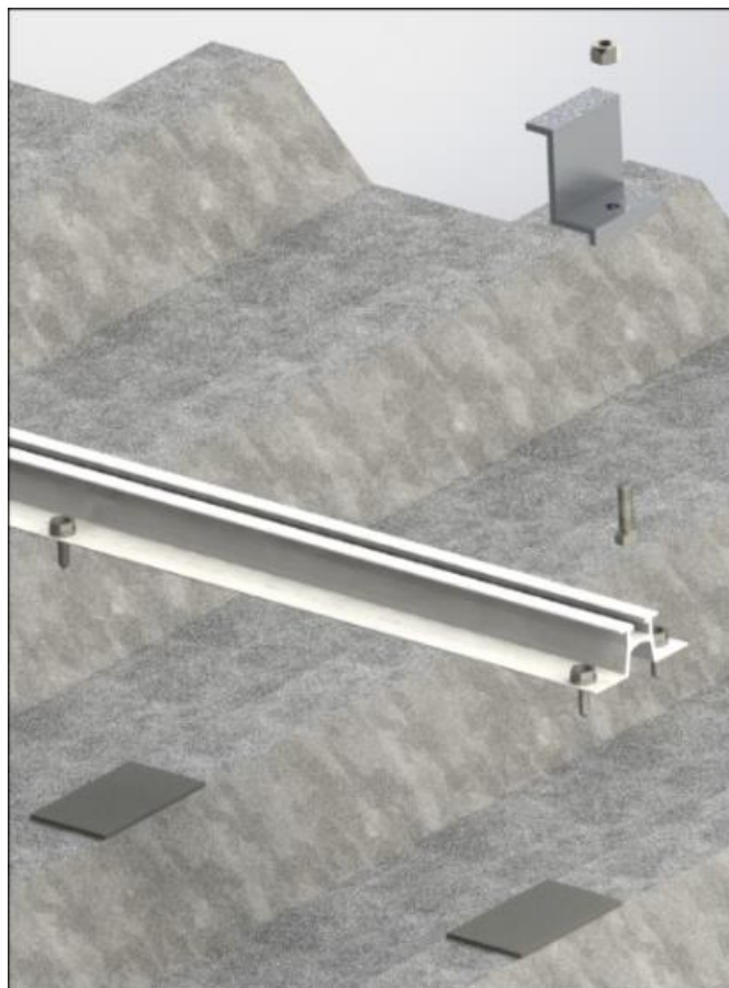
Figura 3 – Suporte tipo trilho para a fixação dos painéis fotovoltaicos
