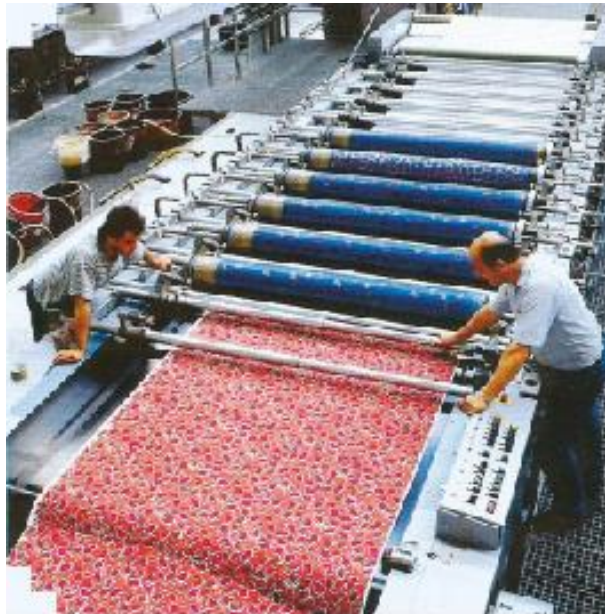
Figura 6 - Produção têxtil de uma estampa de seis (6) cores em uma impressora rotativa.
