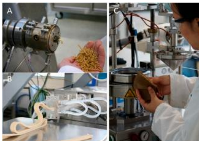
Figura 35 - Obtenção de proteínas vegetais texturizadas por tecnologias top-down: (A) extrusão de baixa umidade, (B) extrusão de alta umidade e (C) célula de cisalhamento.
