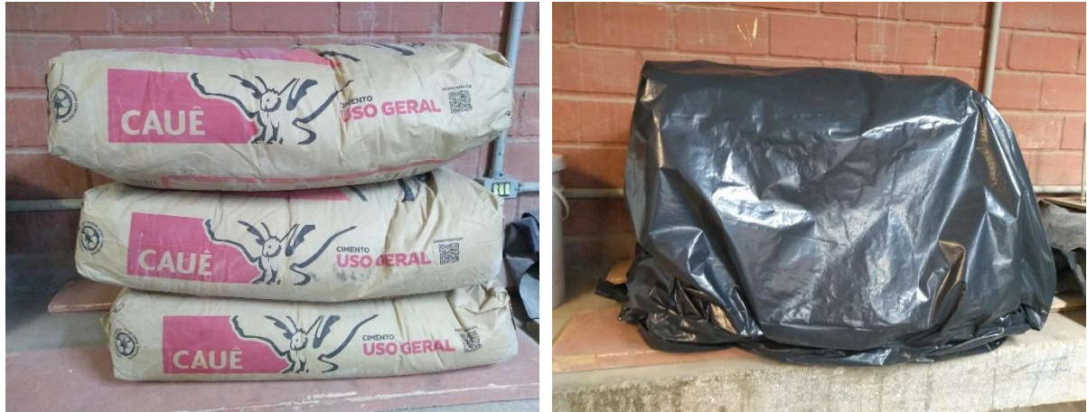
Figura 9 – Armazenamento do cimento CP IV utilizado
