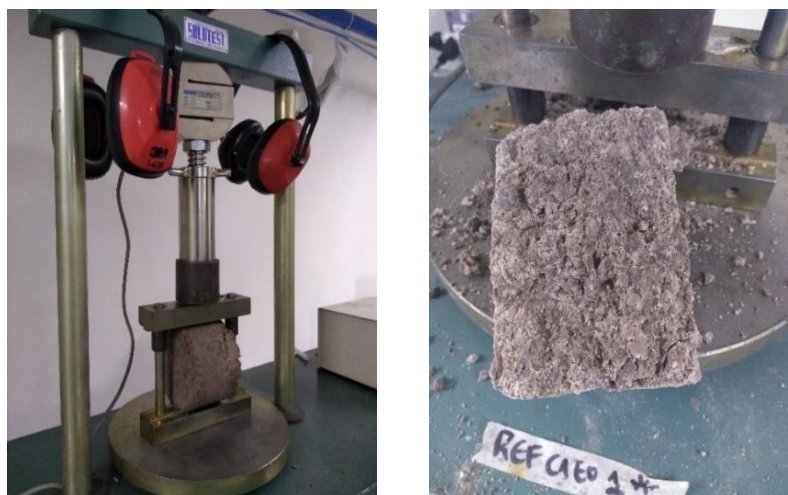
Figura 4 – Ensaio de RT para amostras sem emulsão asfáltica
