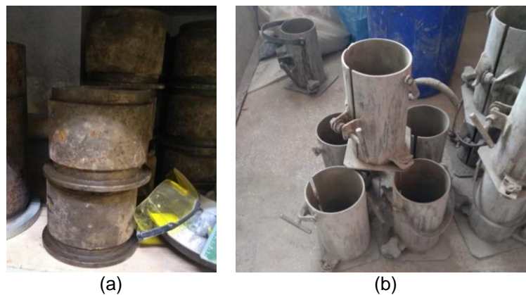
Figura 12 – Moldes cilíndricos para a pesquisa – (a) Ensaio de RT/MR; (b) Ensaio de RCS
