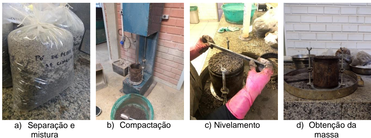
Figura 11 – Ensaio de compactação Proctor
