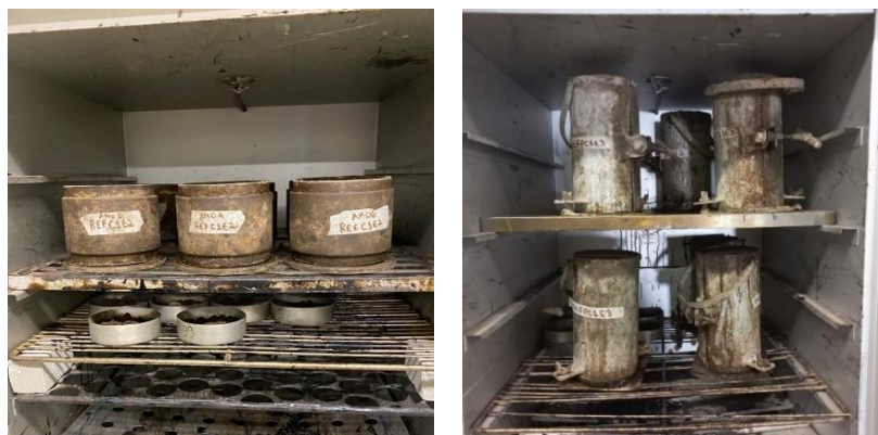
Figura 13 – Amostras moldadas curando em estufa à 60°C
