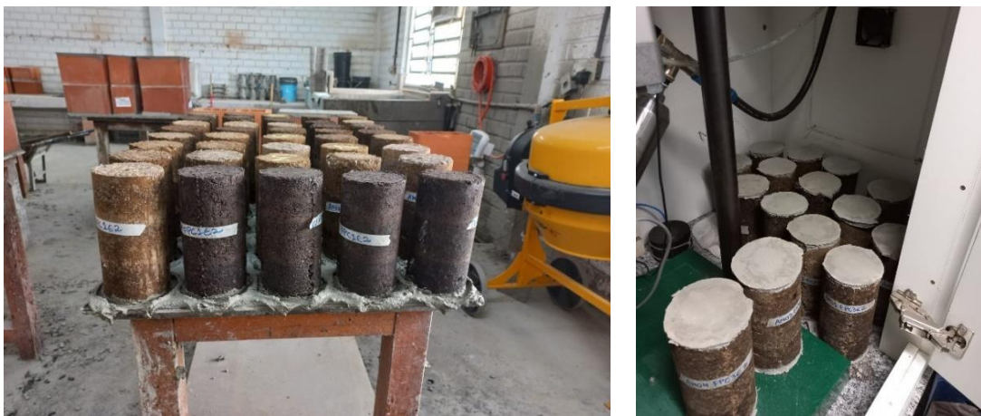
Figura 17 – Amostras de RCS capeadas com 3mm de argamassa
