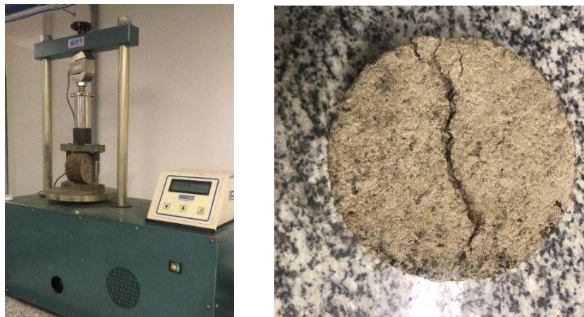
Figura 18 – Prensa dedicada ao ensaio de RT e corpo de prova rompido
