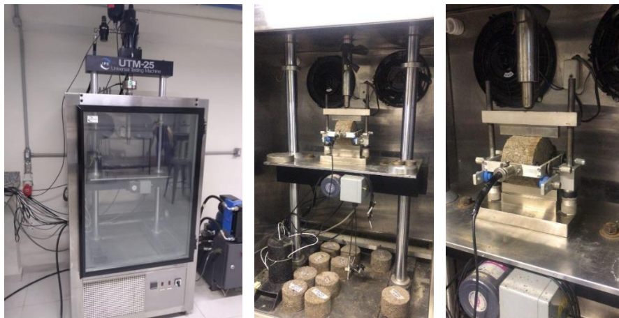
Figura 19 – Prensa UTM – 25 dedicada ao ensaio de MR e amostras sendo ensaiadas
