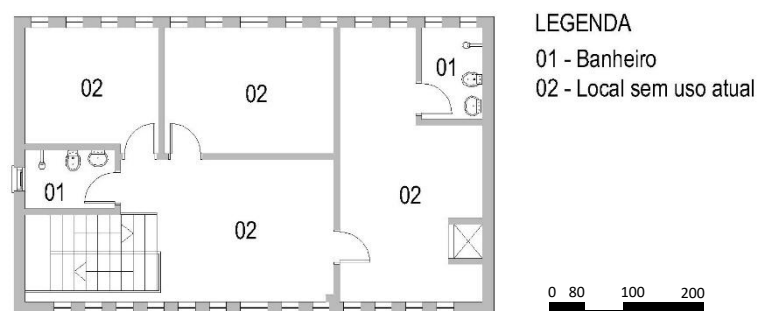
Figura 27 - Planta Baixa Estação Férrea - Segundo Pavimento.
