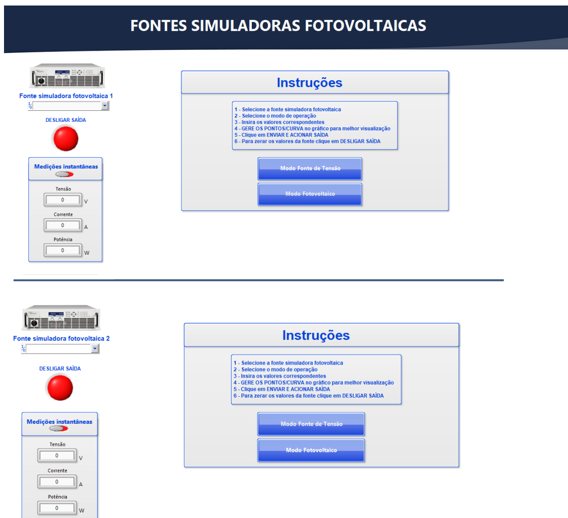
Figura 31 - Tela fontes fotovoltaicas
