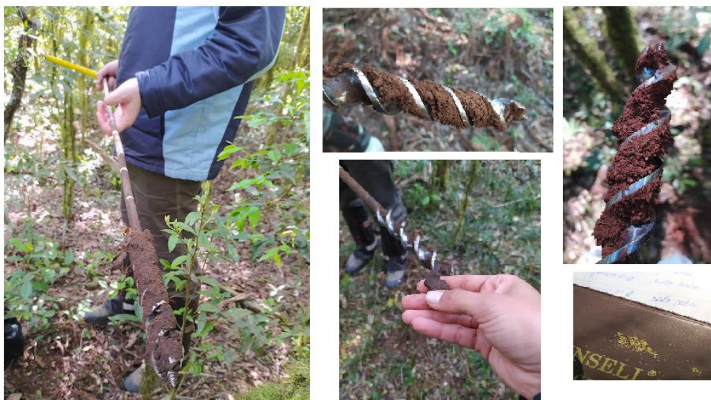
Figura 3 - Obtenção dos atributos do solo com trado holandês na Floresta Nacional de São Francisco de Paula, RS, Brasil
