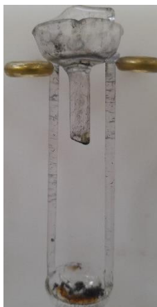
Figura 9. Suporte de quartzo com fuligem devido a combustão incompleta na condição com 600 mg de amostra.
