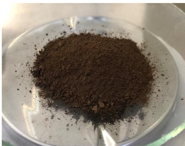
Figura 8. Lignina purificada do processo kraft.
