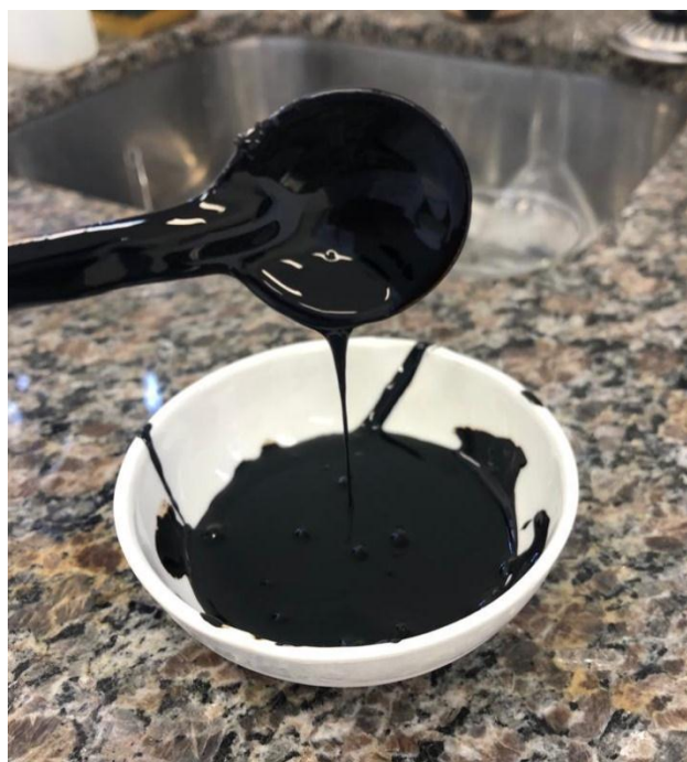
Figura 7. Licor negro com elevada concentração de sólidos.
