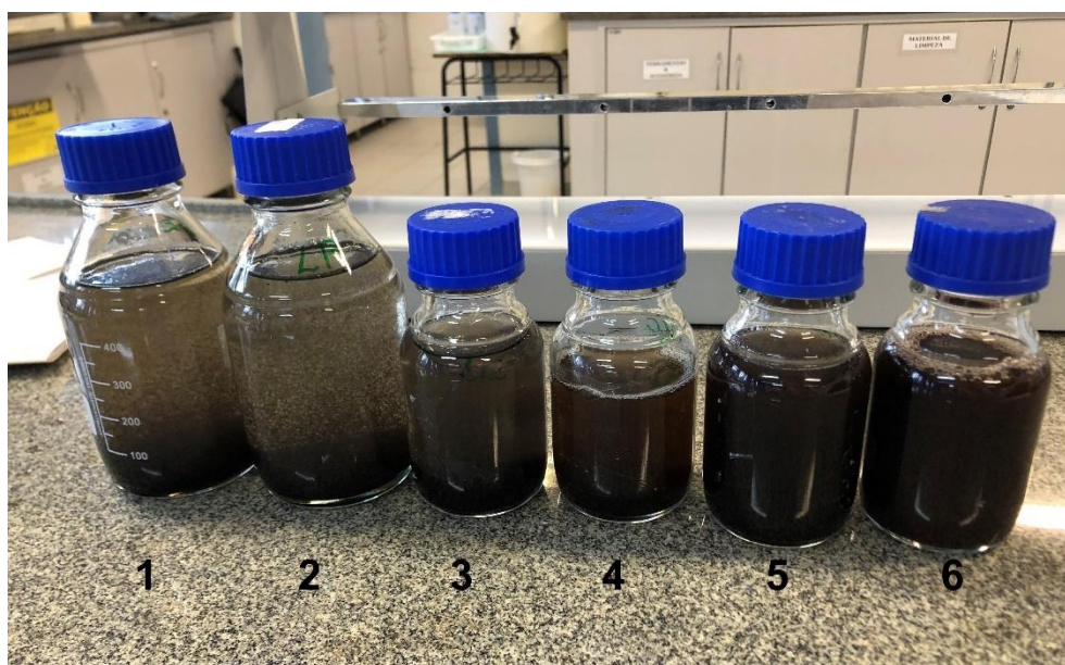
1. LE Lignina E. grandis ; 2. LP Lignina P. taeda ; 3. LPC Lignina P. Taeda Catiônica; 4. LEC Lignina E. grandis Catiônica; 5. LK Lignina kraft e 6. LKC - Lignina kraft catiônica. Fonte: Autora (2022).
