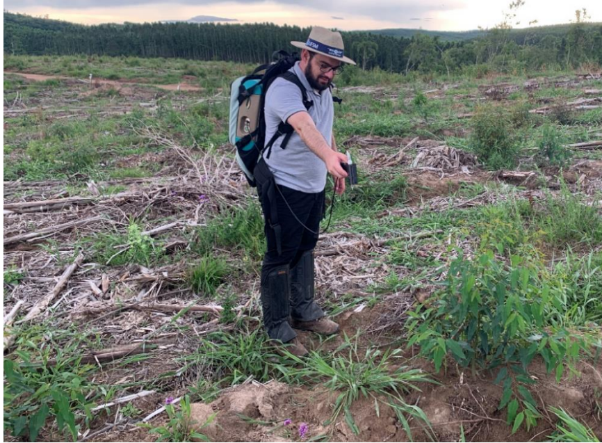
Figura 12 - Tomada de leitura espectral de planta espontânea utilizando o espectrorradiômetro FieldSpec® 3
