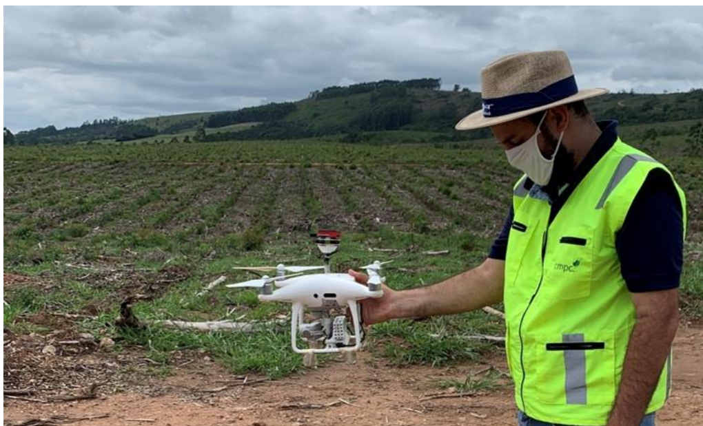
Figura 29 - Imagem do RPAS Phantom 4 Pro embarcado com os sensores CMO, Parrot Sequoia e Sunshine, durante levantamento na área do estudo
