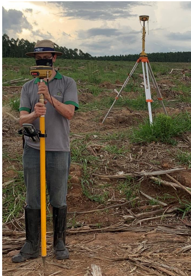
Figura 30 – Levantamento GNSS na área de estudo. Base, rover e coletora do GNSS com RTK HIPER V da Topcon
