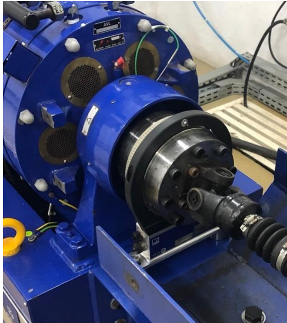
Figura 18 - Flange de torque HBM T40B comissionado na bancada dinâmométrica.
