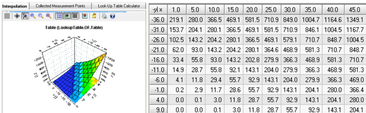
Figura 4 - Fator de sobreposição de válvulas OF implementado no sistema AVL Puma
