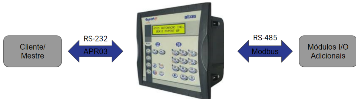
Figura 3.6 – Modelo do CLP utilizado mostrando as interfaces de comunicação.
