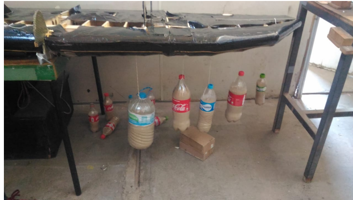
Figura 5.7 – Ensaio Estático realizado pela equipe Carancho.
