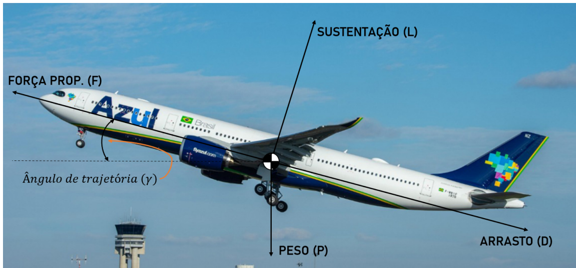
Figura 2.4 – Principais forças atuantes numa aeronave.
