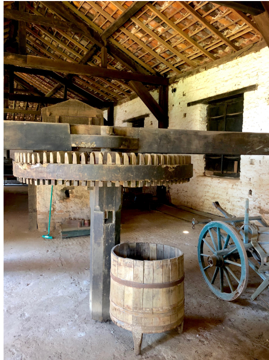
Figura 16 — Galpão e maquinários da Atafona, utilizados na produção de farinha de mandioca, possivelmente desde fins do século XVIII e início do século XIX, na Estância São José, hoje Fazenda da Tafona
