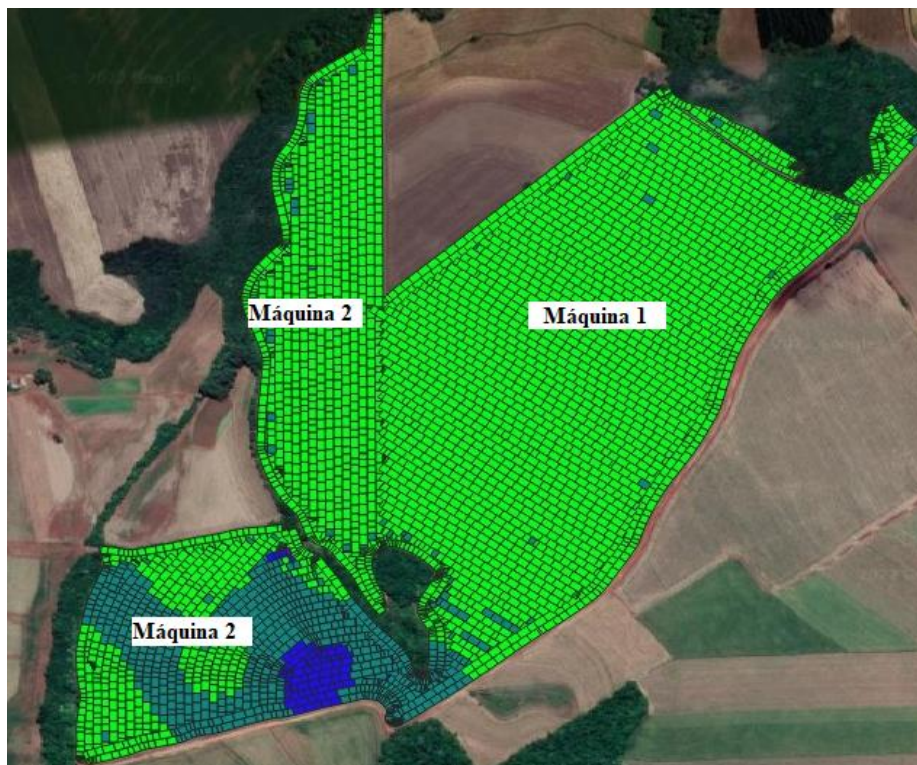
Figura 11 – Mapa de rastreabilidade do trabalho realizado pelas máquinas 1 e 2 na Aplicação C.
