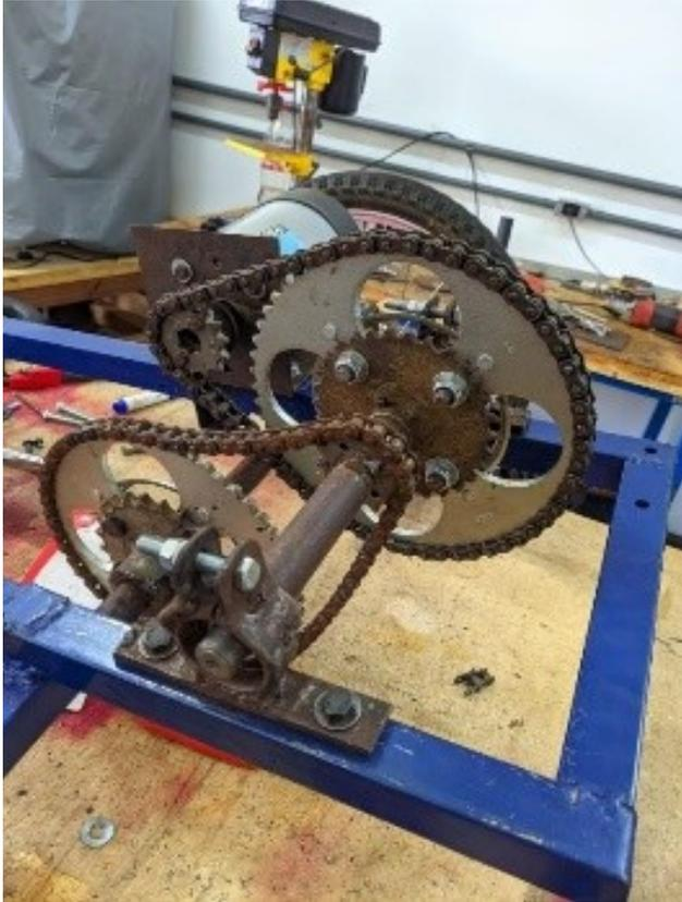
Fig. 4. Sistema de redução implementado.
