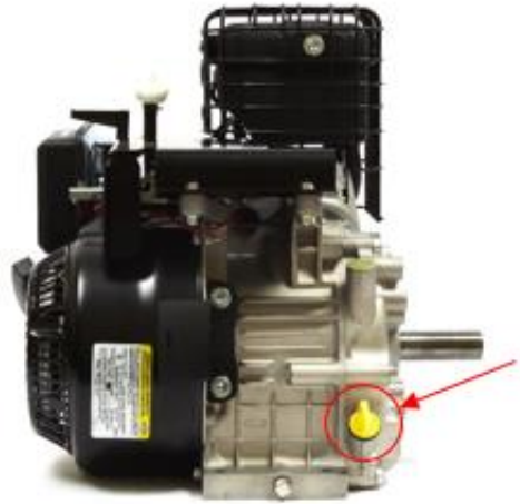
Figura 16 - Posição para utilização do sensor de temperatura
