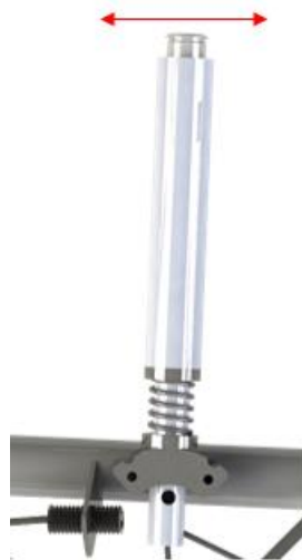
Figura 18 - Posicionamento do sensor de indicação de marcha
