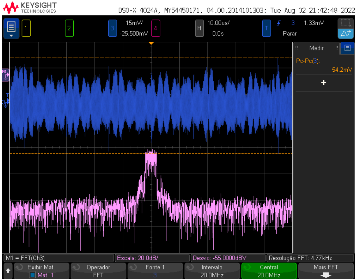
Figura 5.4 – Envoltória do sinal OFDM no tempo para frequência de portadora em 20MHz.
