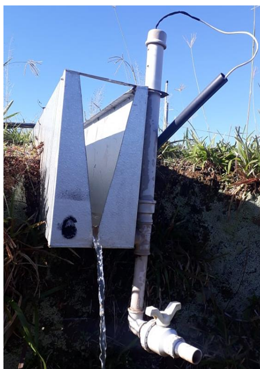
Figura 3 - Calha coletora d'água e, a sua direita, tubo em que foi instalado o sensor MPX 5010 DP.
