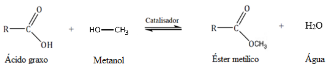
Figura 8 - Reação de esterificação de ácido graxo com metanol
