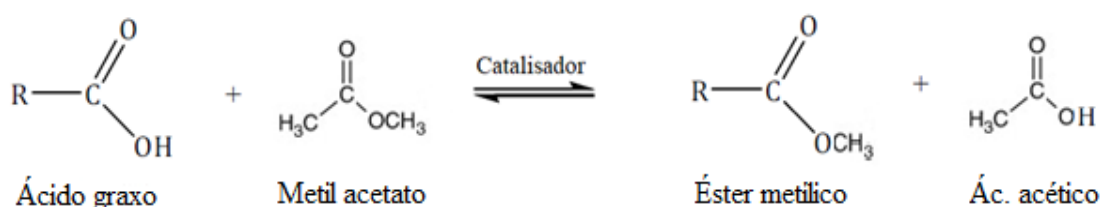
Figura 9 - Reação de transesterificação de ácido graxo com acetato de metila.
