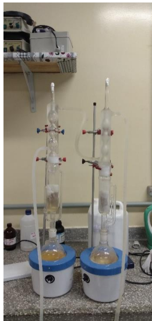
Figura 13 - Sistemas para o procedimento de determinação de extrativos.
