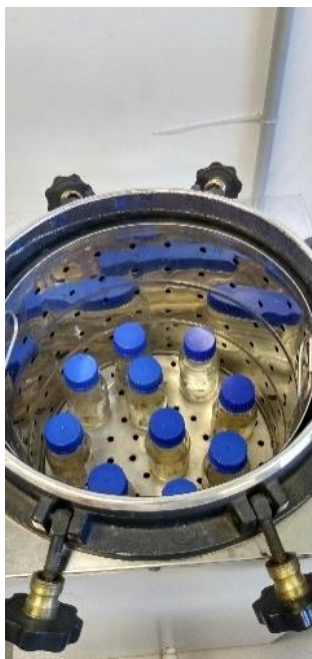
Figura 15 - Frascos dispostos dentro do equipamento de autoclavagem.
