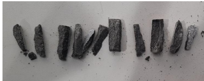
Figura 29 - Rompimento de amostras ensaiadas com aplicação de força no sentido paralelo à direção de impressão.
