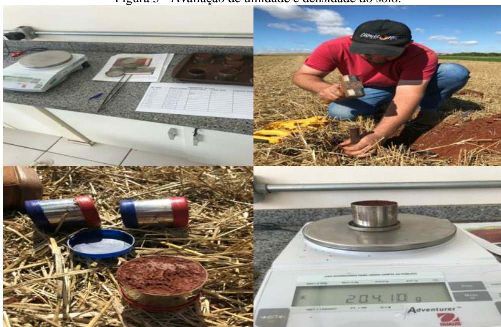
Figura 5 - Avaliação de umidade e densidade do solo.
