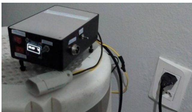
Figura 61 - Protótipo do controlador de temperatura
