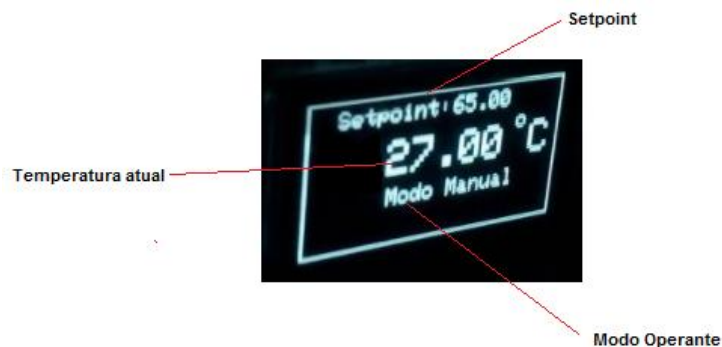
Figura 60 - Display no modo manual de operação do controlador
