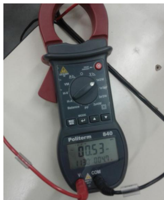
Figura 47 - Wattímetro Alicates monitorando a potência
