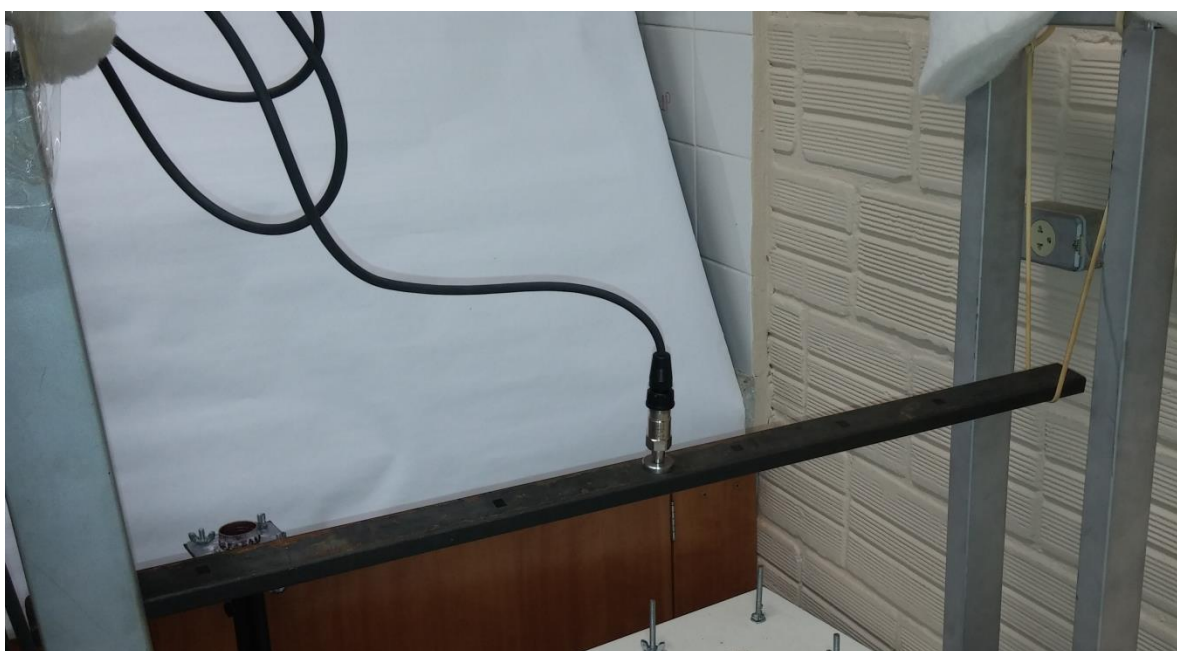
Figura 26 - Acelerômetro fixado à viga.
