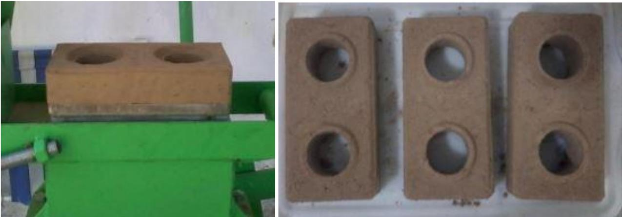
Para as proporções de misturas entre solo e cimento foram adoto o padrão máximo da parte de cimento, ou seja, uma proporção de 10:1, o que corresponde a 10 (dez) partes de solo para 1 (um) parte de cimento.
