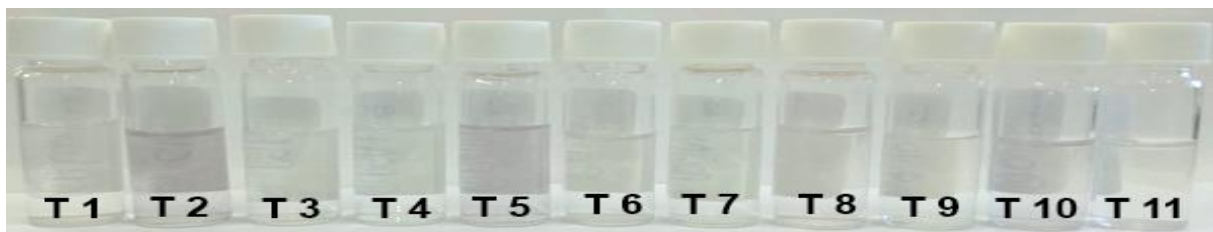
Figura 14 - Extratos das amostras (T1 a T11) empregando o método QuEChERS realizados para avaliação da etapa de limpeza com diferentes sorventes.
