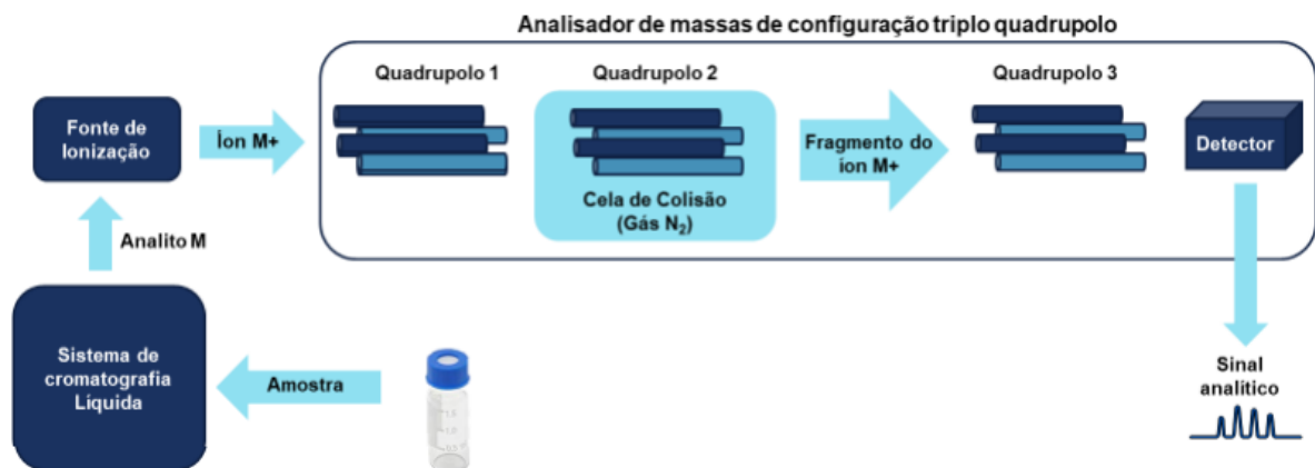
Figura 2 - Configurações de um sistema de cromatografia líquida acoplada a um espectrômetro de massas em série tipo triplo quadrupolo.
