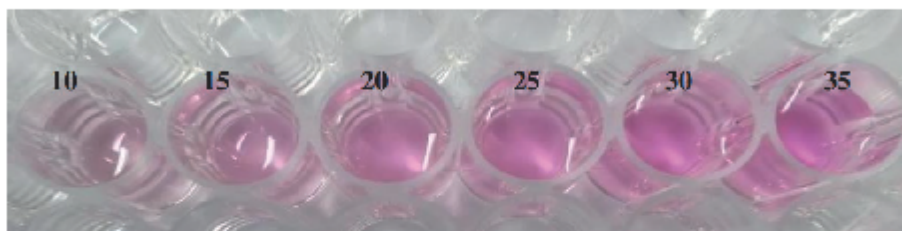
Figura 1. Intensidade de cor do \text{KMnO}_4 em função da concentração ( \text{mg L}^{-1} ).
