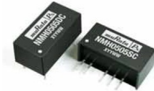
Figura 57: Conversor CC/CC isolado. Fonte: Folha de dados do fabricante (Murata).
