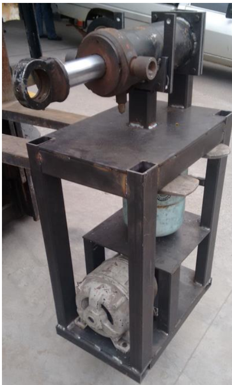
Figura 11 – Montagem da estrutura da máquina.
