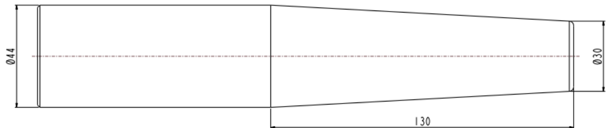
Figura 8 - Medidas principais da segunda peça do ferramental.
