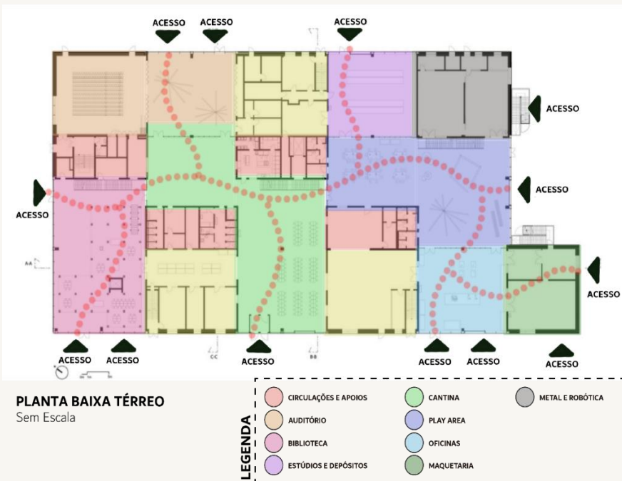
Figura 51 – Planta baixa do pavimento térreo do edifício da Escola de Arquitetura de Aarhus, zoneada pelos usos.
