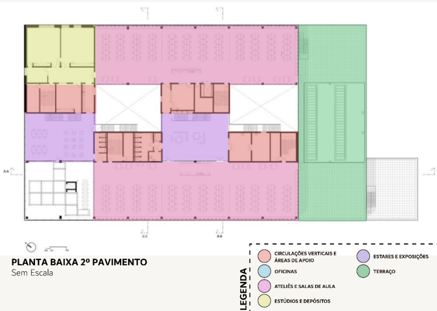
Figura 53 - Planta baixa do 2º pavimento do edifício da Escola de Arquitetura de Aarhus, zoneada pelos usos.
