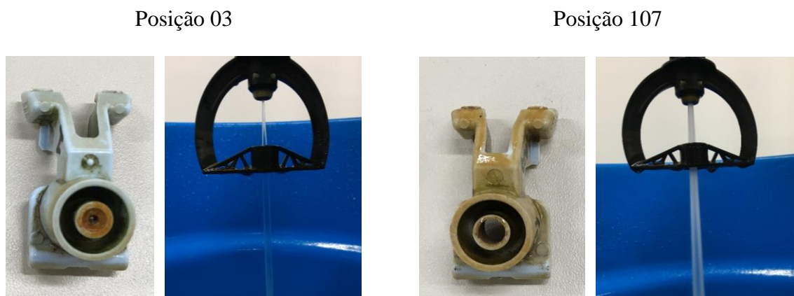
Figura 16 - Aspecto visual dos bocais das posições “03” e “107” e seus jatos durante realização dos ensaios.
