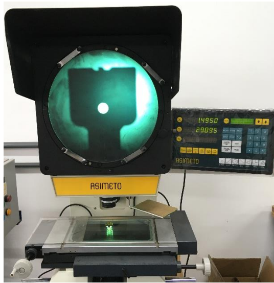
Figura 6 - Projetor de perfil utilizado para medição de diâmetros dos bocais
