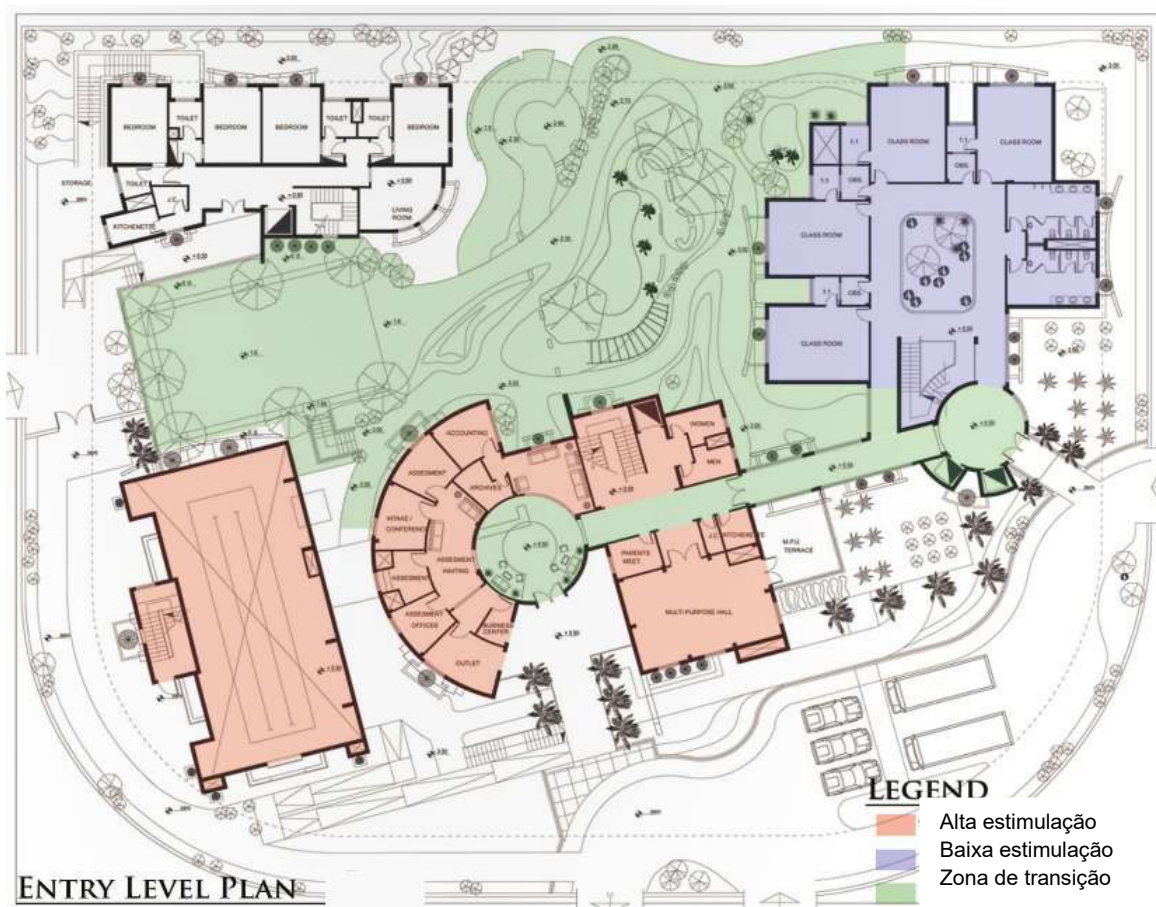
Figura 20 – Planta baixa com delimitação de zonas sensoriais. Fonte: MOSTAFA, 2014, adaptado pela autora.
