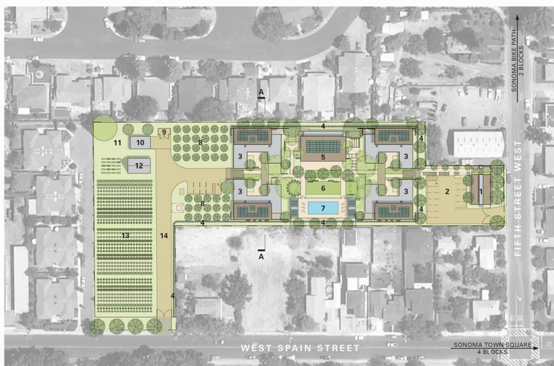
1 ACESSO 2 ESTACIONAMENTO 3 CASA 4 TRATAMENTO DE ÁGUAS PLUVIAIS 5 CENTRO COMUNITÁRIO 6 PRAÇA 7 PISCINA TERAPÊUTICA 8 POMAR 9 LIXEIRA 10 DEPÓSITO 11 POÇO 12 ESTUFA 13 HORTA 14 SAÍDA EMERGENCIA
