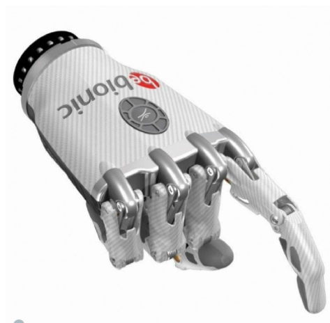
Figura 3.4 – Mão biônica - Bebionic - Ottobock.
