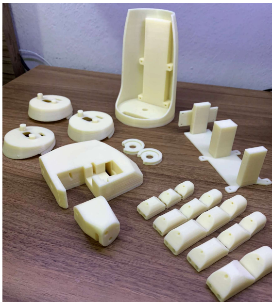
Figura 5.6 – Peças para a montagem da prótese.
