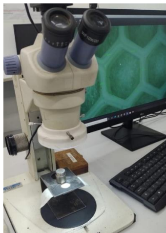
Figura 13 – Avaliação do formato e dimensões dos enchimento honeycomb em microscópio ótico.
