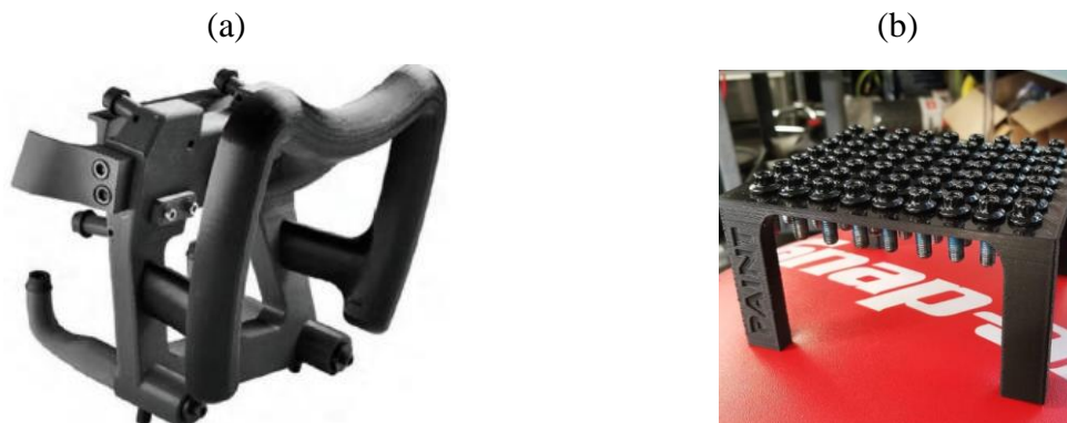
Figura 7 – Dispositivos 1 (a) de montagem no processo de fabricação da BMW; 2 (b) suporte para pintura de parafusos.
