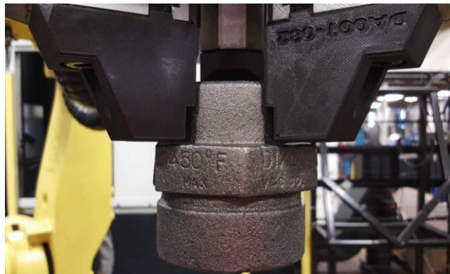
Figura 8 – Garras usadas em braços robóticos automatizados
