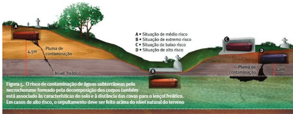
Figura 6 - Risco de contaminação pela percolação de necrochorume
