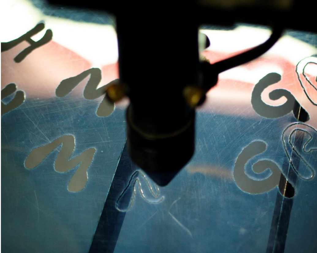
Figura 57 – Processo de corte do estêncil a laser. 2022.
