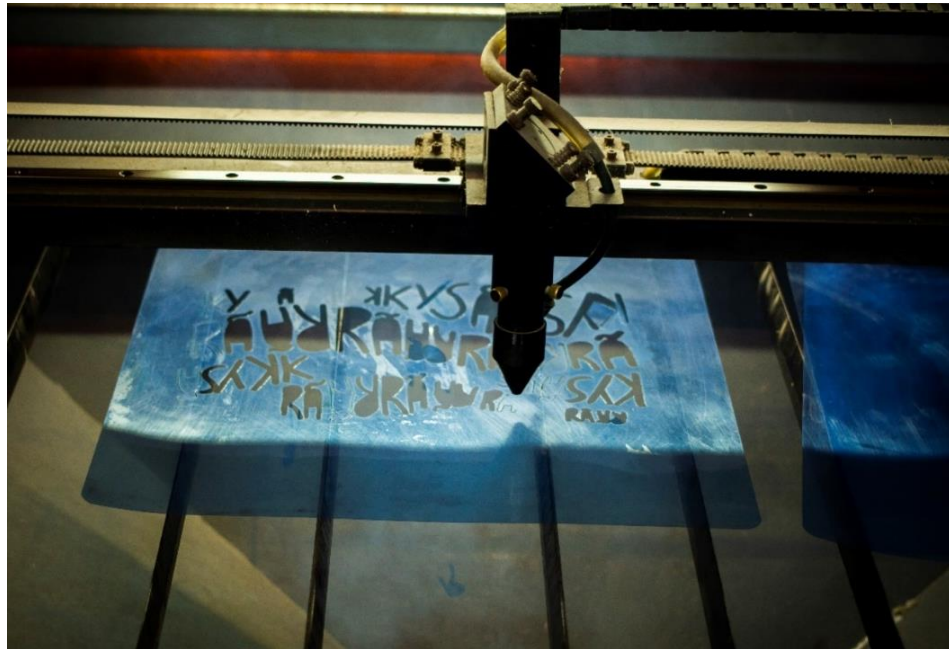
Figura 55 – Processo de corte do estêncil a laser. 2022.
