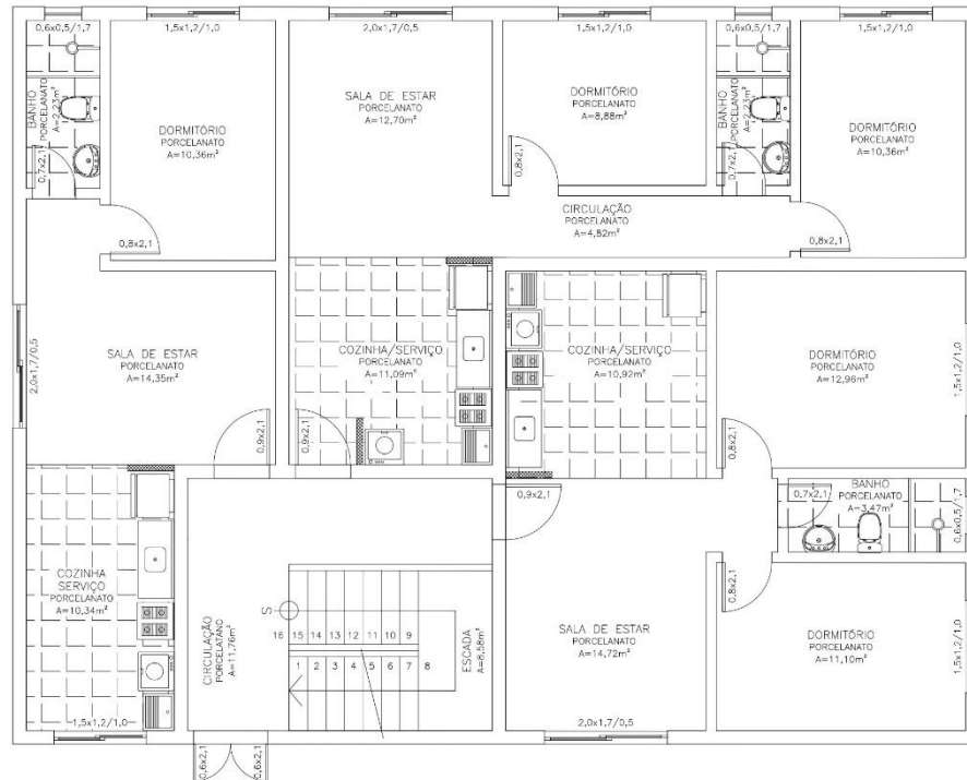
Figura 13 – Planta-baixa do pavimento térreo.
