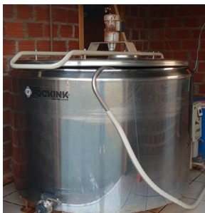
Figura 10 - Tanque de refrigeração
