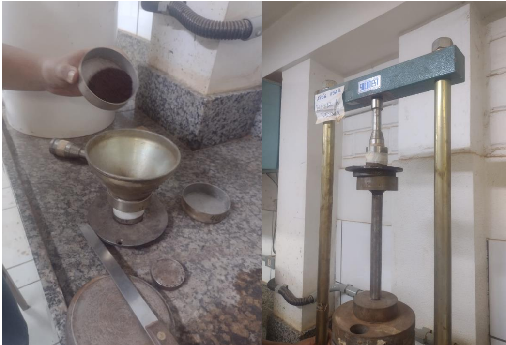
Figura 28– Moldagem do corpo de prova na prensa estática
