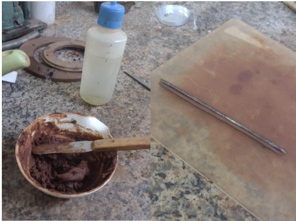
Figura 24– Ensaio de Limite de plasticidade
