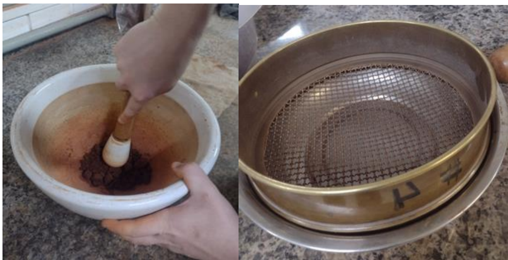
Figura 20- Destorroamento e peneiramento da amostra
