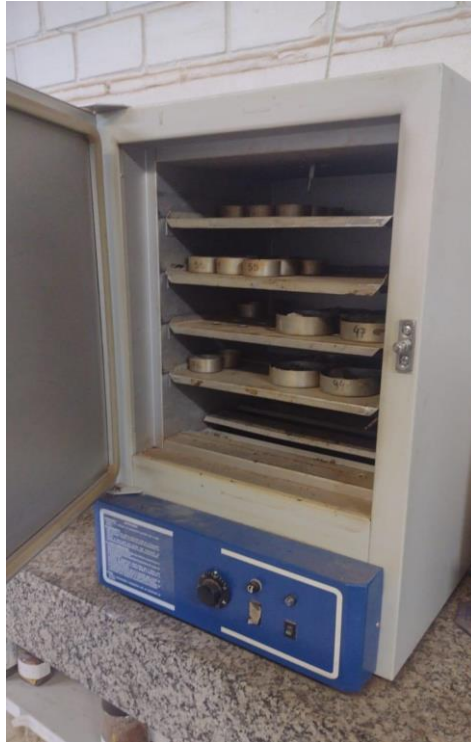
Figura 22– Secagem da amostra do material em estufa
