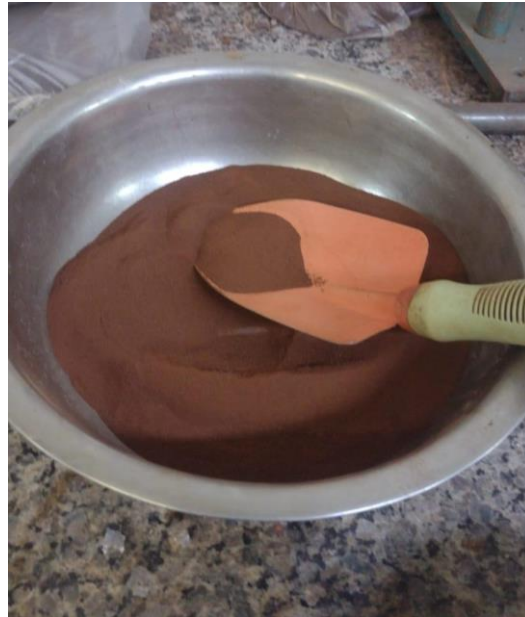
Figura 23– amostra de solo passante na peneira de nº 40
