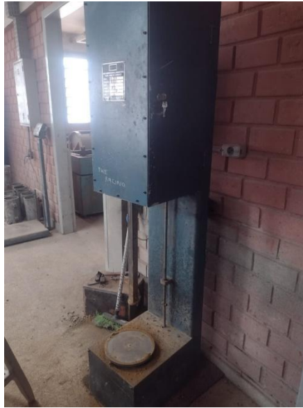
Figura 26– Compactação com o aparelho Proctor.
