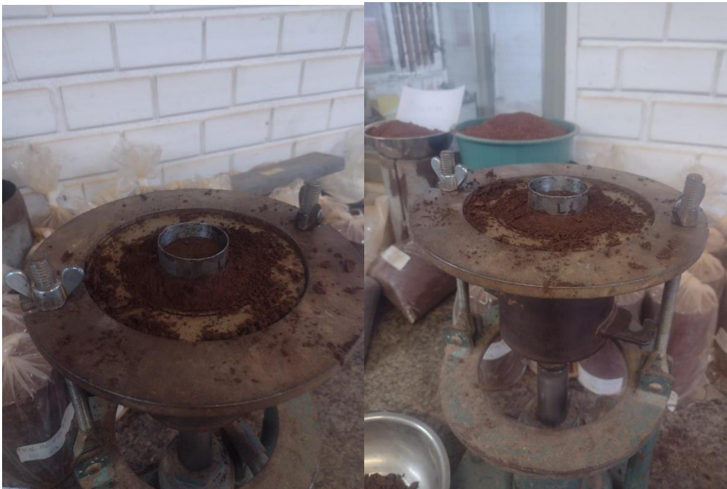
Figura 27– Moldagem do corpo de prova através da extração
