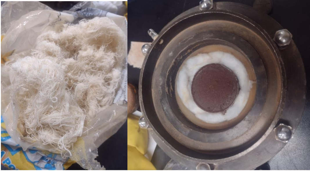
Figura 33– Materiais utilizados para evitar a a redução do teor de umidade do corpo de prova
