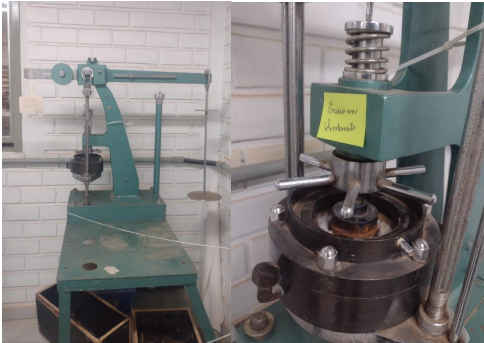
Figura 32– Ensaio edométrico simples
