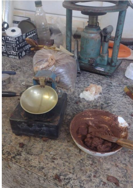
Figura 25– Ensaio de Limite de liquidez
