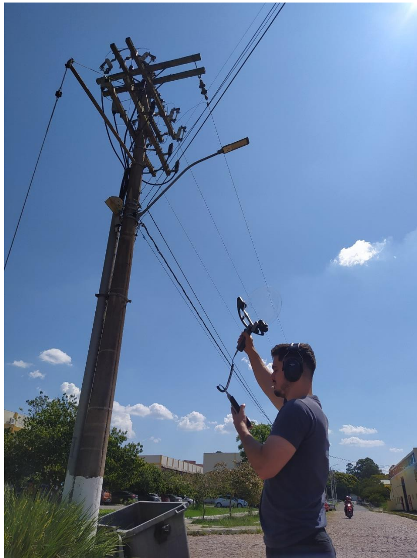
Figura 5 – Inspeção de Ultrassom.
