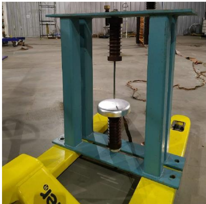
Figura 12 – Arranjo ponta-plano utilizado para os ensaios.
