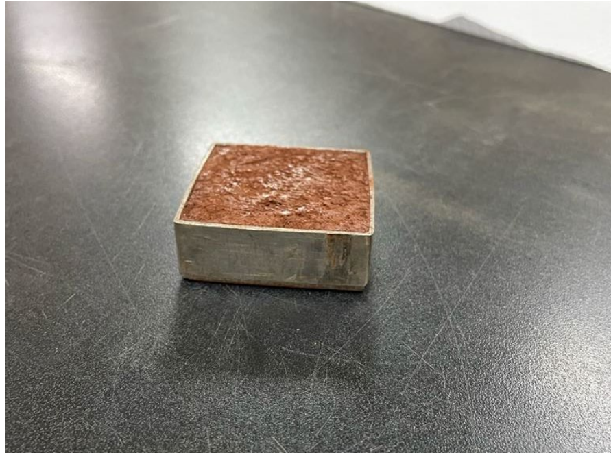
Figura 8 - Corpo de prova moldado na prensa estática.
