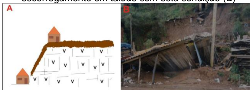
Figura 8:- Ilustração de uma situação de contato solo – rocha (A) e um escorregamento em talude com esta condição (B)
