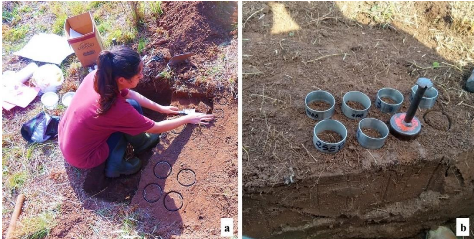
Figura 7 – Coleta de amostras com estrutura preservada com anéis metálicos de 9,8 cm de diâmetro e 2,8 cm de altura (a) e anéis de 5,7 cm de diâmetro e 3 cm de altura (b).
