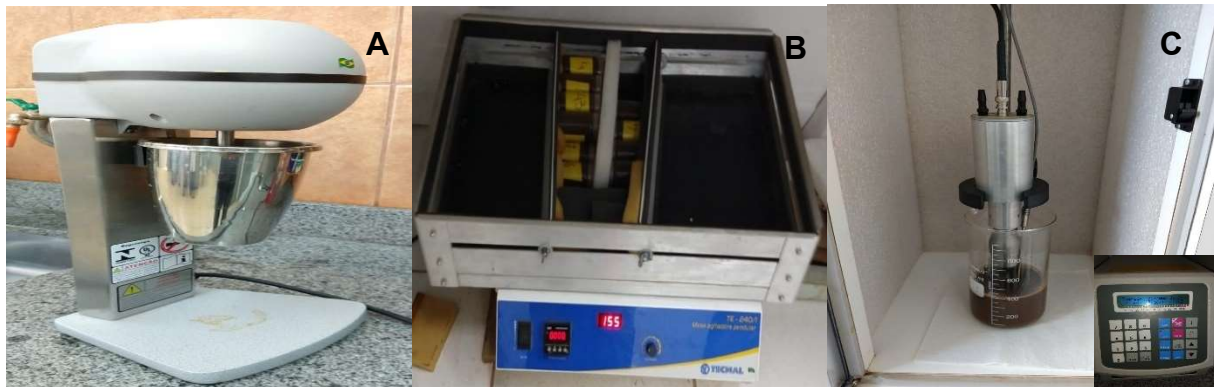
Figura 4 – Agitador tipo coqueteleira (A), agitador horizontal recíprocante (B) e agitador ultrassônico (C).
