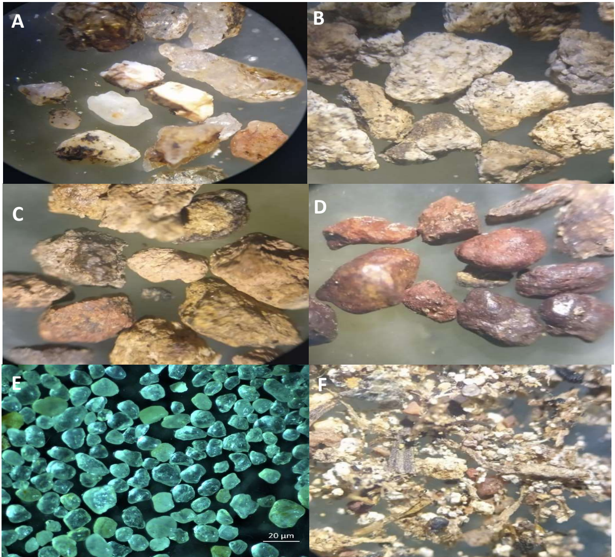
A: quartzos, B: fragmentos de saprolito, C: fragmentos de rocha; D: magnetita; E: areia composta por quartzos (AQTZ) (comparativa), F: agregados de resíduos orgânicos com minerais.
