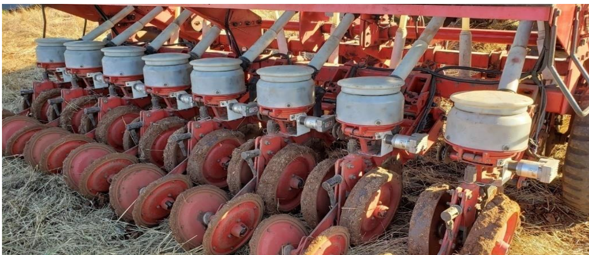
FIGURA 2. Semeadora Semeato®, modelo SHM 15/17, equipada com motores elétricos linha a linha e usada na semeadura dos experimentos.
