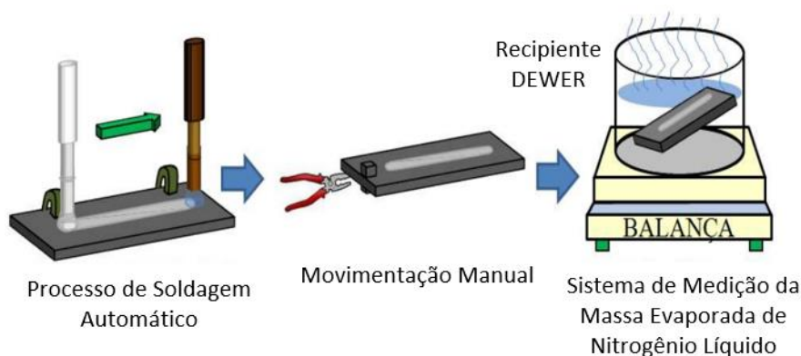
Figura 13 - Calorímetro de Nitrogênio Líquido utilizado por Kenney, Miller e Smartt. (1998).
