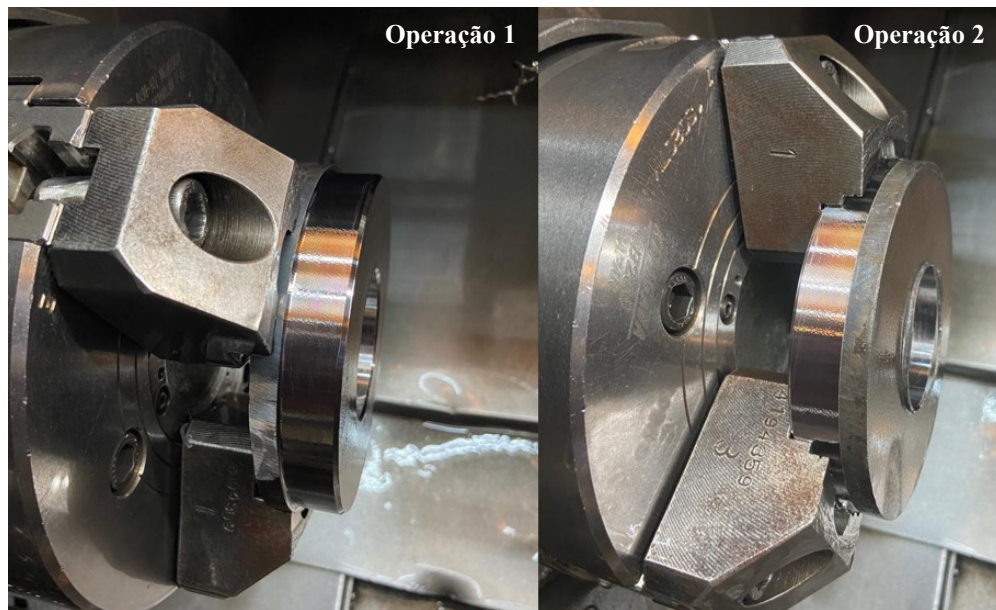
Figura 25 – Fixação da peça na placa em dois estágios (operação 1 e operação 2).
