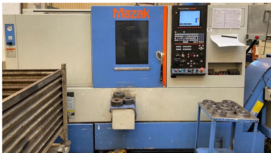
Figura 24 – Fotografia do centro de torneamento adotado para realização das operações de torneamento
